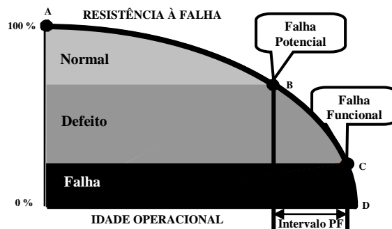
Figura 1 – Curva de Resistência a Falha
