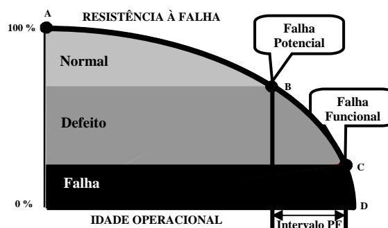
Figura 1 – Curva de Resistência a Falha
